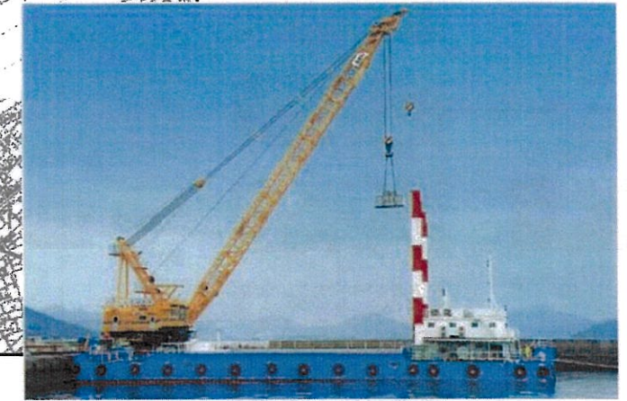
起重機船(150t吊)
