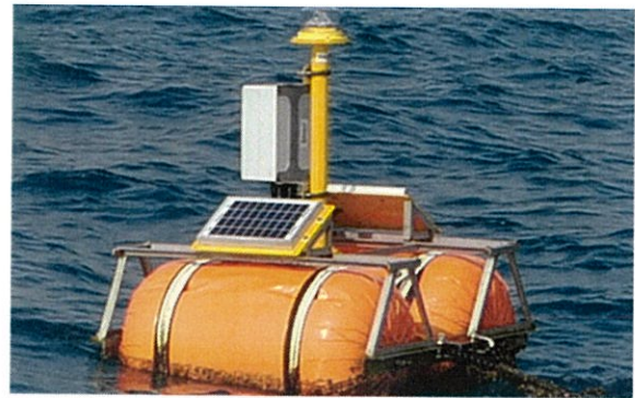
観測ブイ 全長:1,440mm 重量:約50kg 浮体:φ450 mm 高さ680 mm KP フロート#VP180VP×2 個
